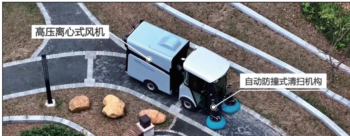
图 6 清扫机构系统图
